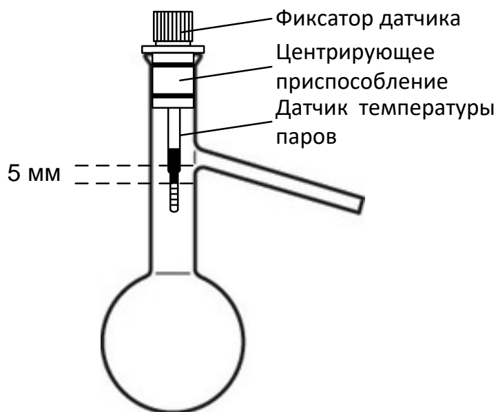
Рисунок 9 - Установка датчика температуры паров в центрирующем приспособлении
