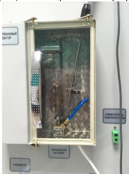
Рисунок 3 – Образцовый термометр в дозаторе
