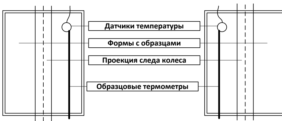
Рисунок 5 - Расположение датчиков на поверхности образца. Вид сверху.
