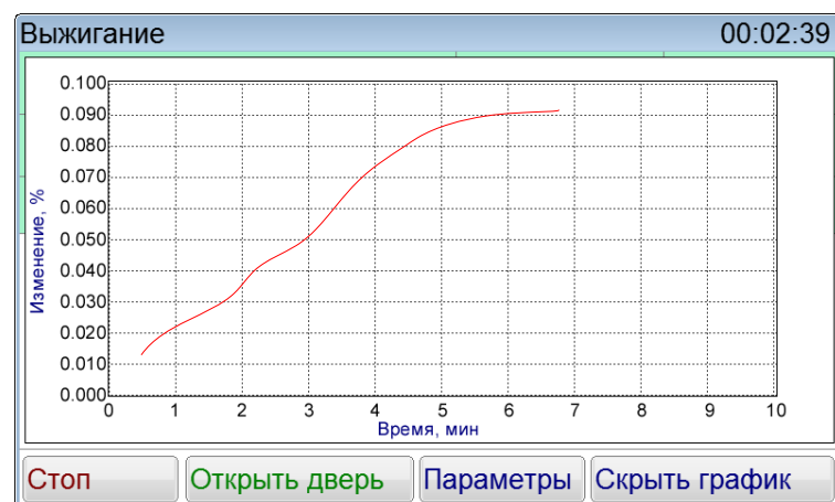
Рисунок 15 – График изменения массы в процессе выжигания
