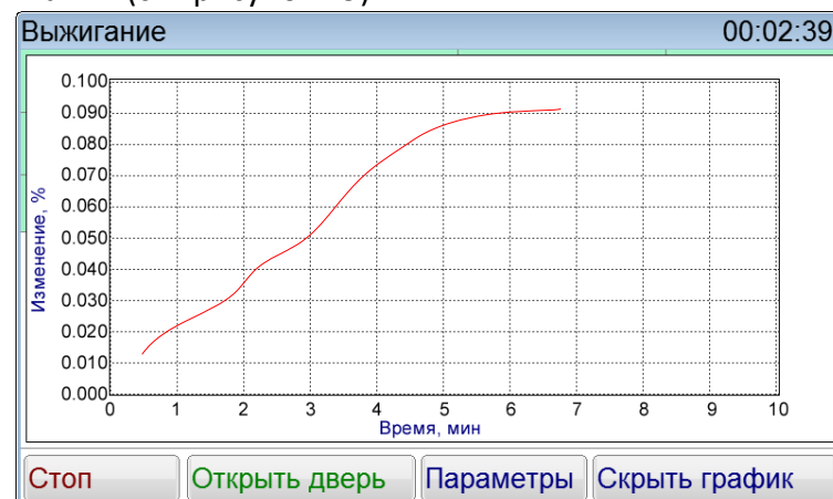
Рисунок 29 – График изменения массы в процессе выжигания
