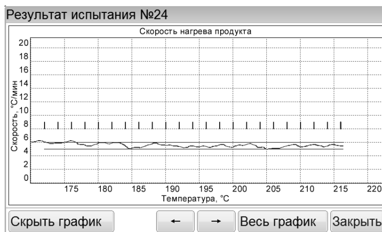
Рисунок 13 – Окно «Результат испытания»: график, зона поджига
