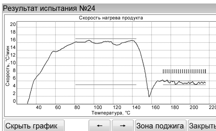
Рисунок 12 – Окно «Результат испытания»: график скорости нагрева
